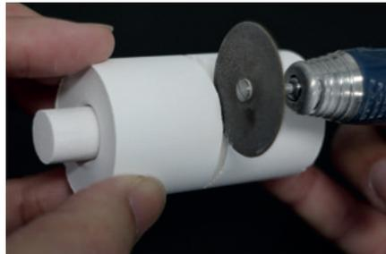
Separare il cilindro con un disco separatore
