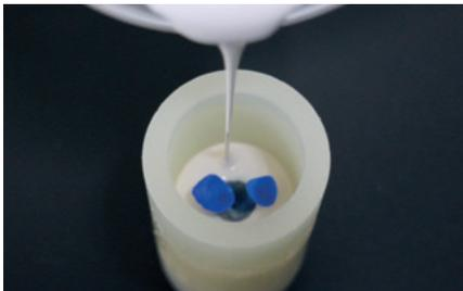
Evitare di formare bolle d'aria quando si riempie il cilindro con il rivestimento.
