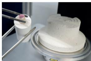
Inserire i pellet VINTAGE PRIME PRESS nel cilindro caldo in modo che la scritta colorata sia sopra.
