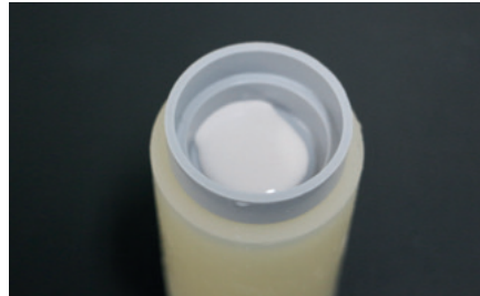
Muffellehre auf die Muffel setzen, damit Ober- und Unterseite parallel zueinander bleiben.
