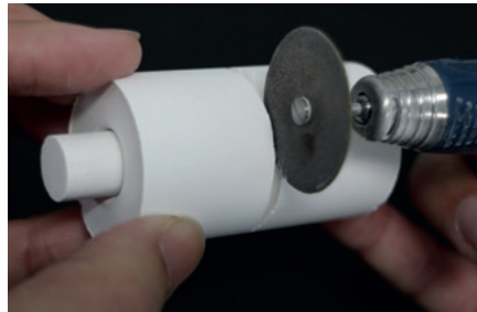
Die Muffel mit einer Trennscheibe separieren.
