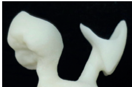
Vollständig ausgebettete Objekte nach der Feinausbettung mit Aluminiumoxid ( \text{Al}_2\text{O}_3 ) bei einem Druck von ca. 0,2-0,3 MPa (2-3 bar).
