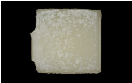
VINTAGE LD Press nach Abstrahlen mit Glasperlen bei 0,3 MPa (3 bar) Druck
