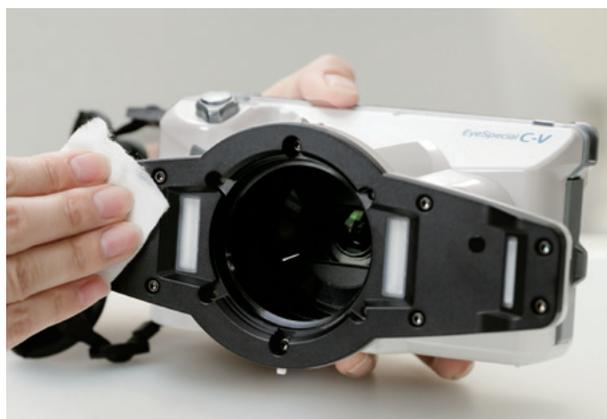
La carcasa totalmente lisa de la cámara EyeSpecial C-V es resistente al agua y a los productos químicos y puede desinfectarse rápida y completamente con un spray de etanol y un paño. De este modo, la cámara queda lista para su uso en la clínica de acuerdo con las directrices de higiene vigentes.
