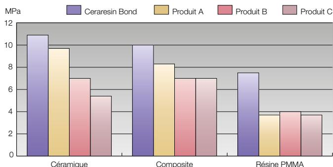
Résistance à l'adhésivité de **Ceraresin Bond** dans la liaison composite / céramique face à d'autres fabricants.
