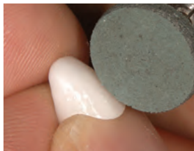
Sagomatura e finitura con lucidanti impregnati di diamante (CoreMaster)
