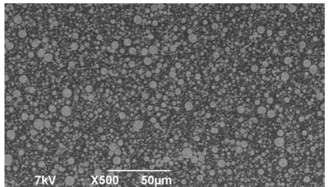
Durch die homogene und verdichtete ultrafeine Partikelstruktur ist Ceramage UP fließfähig und dennoch standfest.
