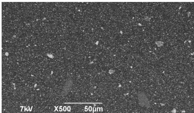
Konventionelle, fließfähige Composite enthalten oft einen geringeren Füllstoffanteil mit einer ungleichen Strukturverteilung.
