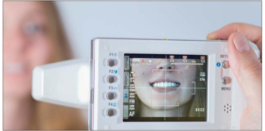
Abb. 2: Das geringe Gewicht, die treffsichere Autofokus-Funktion und ein optisches Stabilisierungsprogramm ermöglichen auch eine einhändige Bedienung der EyeSpecial C-III.
