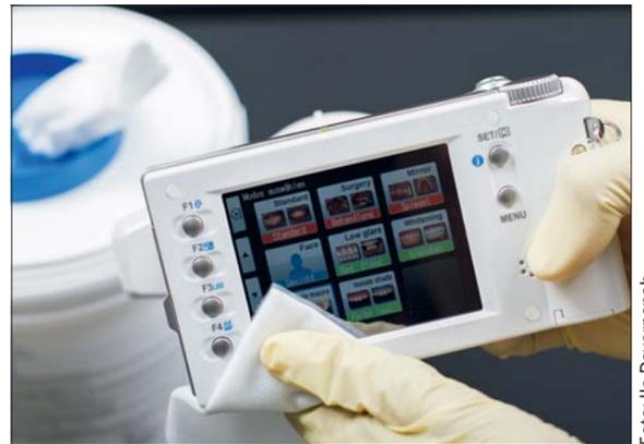
Abb. 8: Die kompakte Bauweise und das abgedichtete Gehäuse erlauben eine einfache und sichere Desinfektion der EyeSpecial-C-III.
