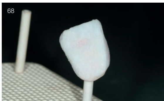
Abb. 68 Nach dem Verdichten mit dem Ceramosonic S kann die Form mit einem entsprechenden Instrument korrigiert und die Krone gebrannt werden
