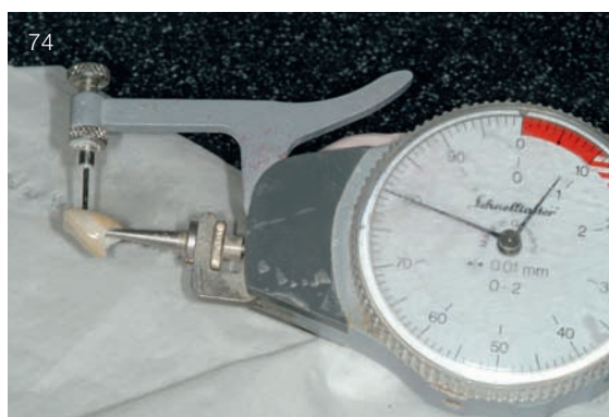
Abb. 74 Die Krone für Zahn 11 weist eine Gesamtschichtstärke von 0,8 mm auf
