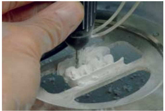
Abb. 20 Zeitgleich werden über einen „Storchenschnabel“ die abgetasteten Informationen auf einen Zirkondioxidbraunling (fälschlicherweise oft Grünling genannt) übertragen und die abgetastete Information herausgefräst.
