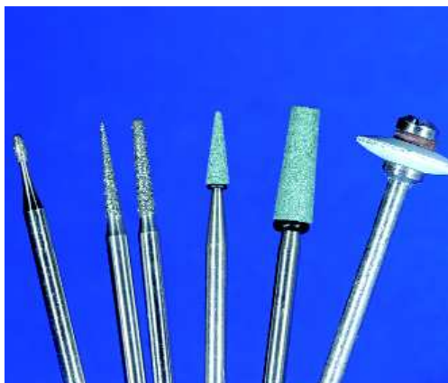
Abb. 23: Der Instrumentensatz: Die Feinkörnigkeit der Dura-Green Schleifkörper von Shofu ermöglichen eine realistische Oberflächentextur.
