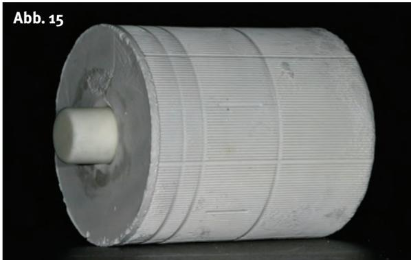
▲ **Abb. 15** Die Oberfläche der Muffel bei Einsatz eines Silikon-Muffelformers erzeugt eine vergrößerte Oberfläche. In der Theorie geht man davon aus, dass die Wärmestrahlung der Heizspirale so besser die Muffel aufheizen kann. In der Praxis stellt sich dieser Faktor in seinem Einfluss auf gering heraus, die Wärmeleitfähigkeit der Einbettmasse ist bedeutsamer für das Gesamtergebnis.
