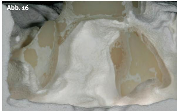
▲ **Abb. 16** Querschnitt Muffel: Vereinfacht gilt: Je heißer die Einbettmasse, desto stärker die Reaktionsschicht. Da eine Muffel im Kern stets kälter ist als an der Außenwand, ist die Ausbildung der Reaktionsschicht dort geringer.
